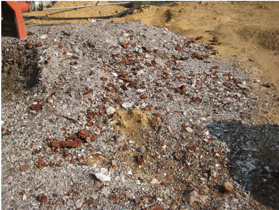
Foto 3: scorie da inceneritore REA, con rottami ferrosi
