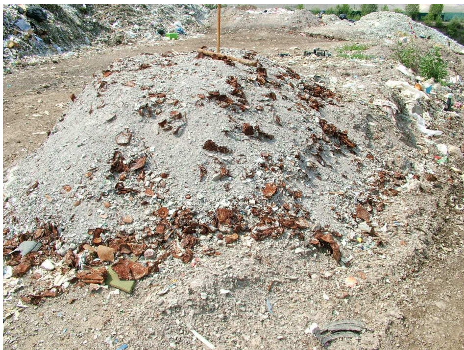
Foto 5: scorie da inceneritore REA, con rottami ferrosi
