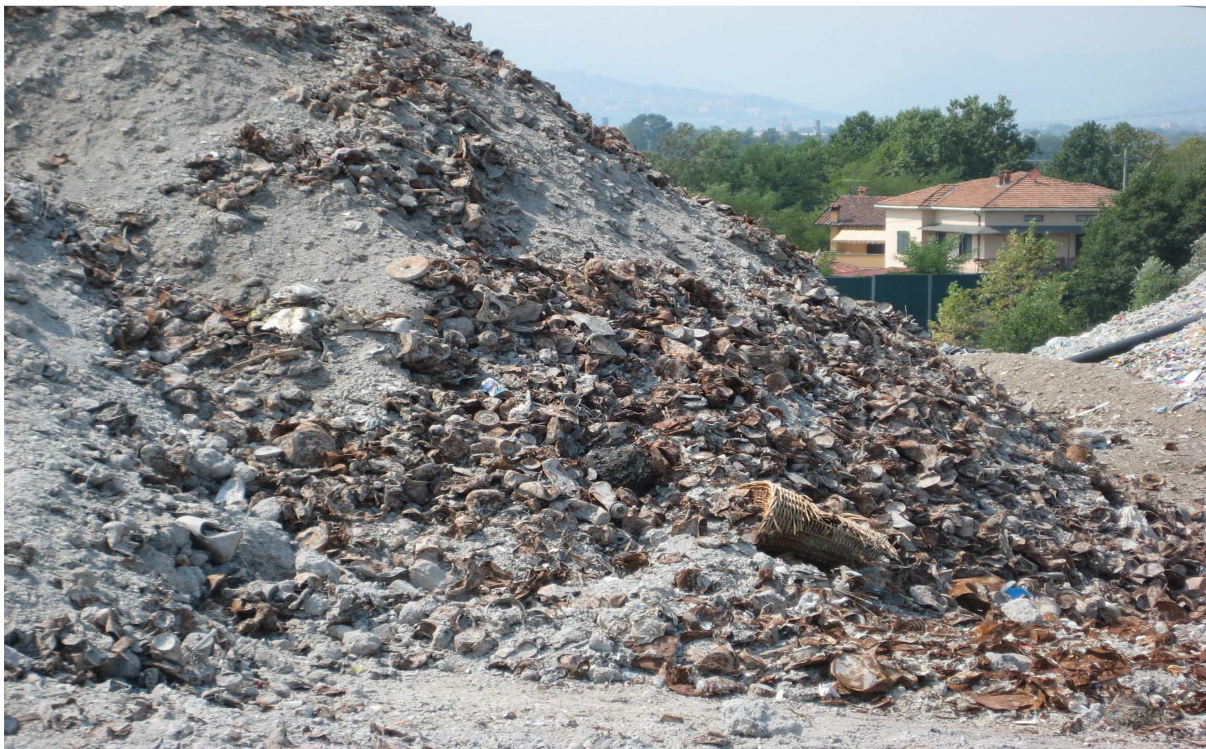
Fotografia 4: Rottami metallici nelle scorie conferite dall'inceneritore REA di Dalmine
