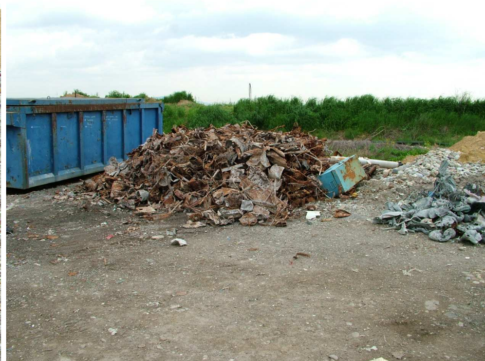
Fotografia 1: Scorie dell'inceneritore e residui ferrosi separati dal gestore della discarica
